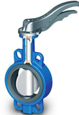
**Valvole a farfalla lug** idonee per impianti idrici di riscaldamento/condizionamento, antincendio e gas, applicazioni industriali, chimiche e alimentari. Sono disponibili da DN 25 a DN 600, minimo ingombro, tenuta morbida, adatte per regolazione, montaggio da effettuarsi tra due controflange, possibilità di montaggio di attuatori elettrici, pneumatici, manuali, sistema di lucchettaggio di serie. Non adatte per vapore. Conformi alla direttiva 97/23/CE (PED).
