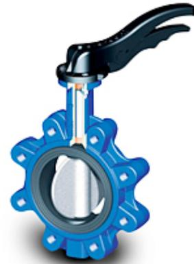
**Valvole a farfalla biflangiate a passo corto.** Sono utilizzate per intercettazione e regolazione in impianti di acquedotti, condizionamento, antincendio e industria. Scartamenti secondo EN 588 serie 1/20, ISO 5752-1, DIN 3202-K1, B5 5155. Temperatura max + 90 °C.
