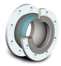
Giunti elastici filettati idonei per impianti idrici, di condizionamento/riscaldamento, applicazioni industriali ed agricole, aria compressa, impianti di pompaggio. La funzione di questi giunti è quella di proteggere gli impianti dai movimenti di: compressione, flessione, allungamento, disassamento, riduzione del colpo d'ariete e assorbimento del rumore.
